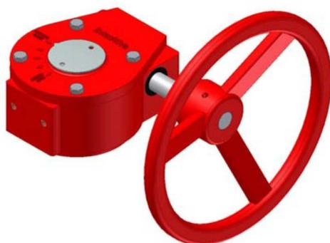
Redutor manual com volante tipo caixa redutora para acionamento de válvulas ¼ de volta. Construção tipo coroa e sem fim. Indicador de posição para a todos os modelos. Acionamento manual por volante. Base de acoplamento conforme ISO 5211. Possui parafusos de ajuste para as posições aberto e fechado. Pintura standard INTERATIVA (Vermelho)\*.
